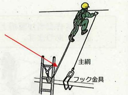
※はしごの踏み機は墜落阻止するための強度が不十分な場合があるので、落下時の荷重が踏み機ではなく、支柱に伝わるようにする。
