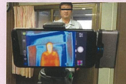
サーモグラフィカメラによる体温計測
